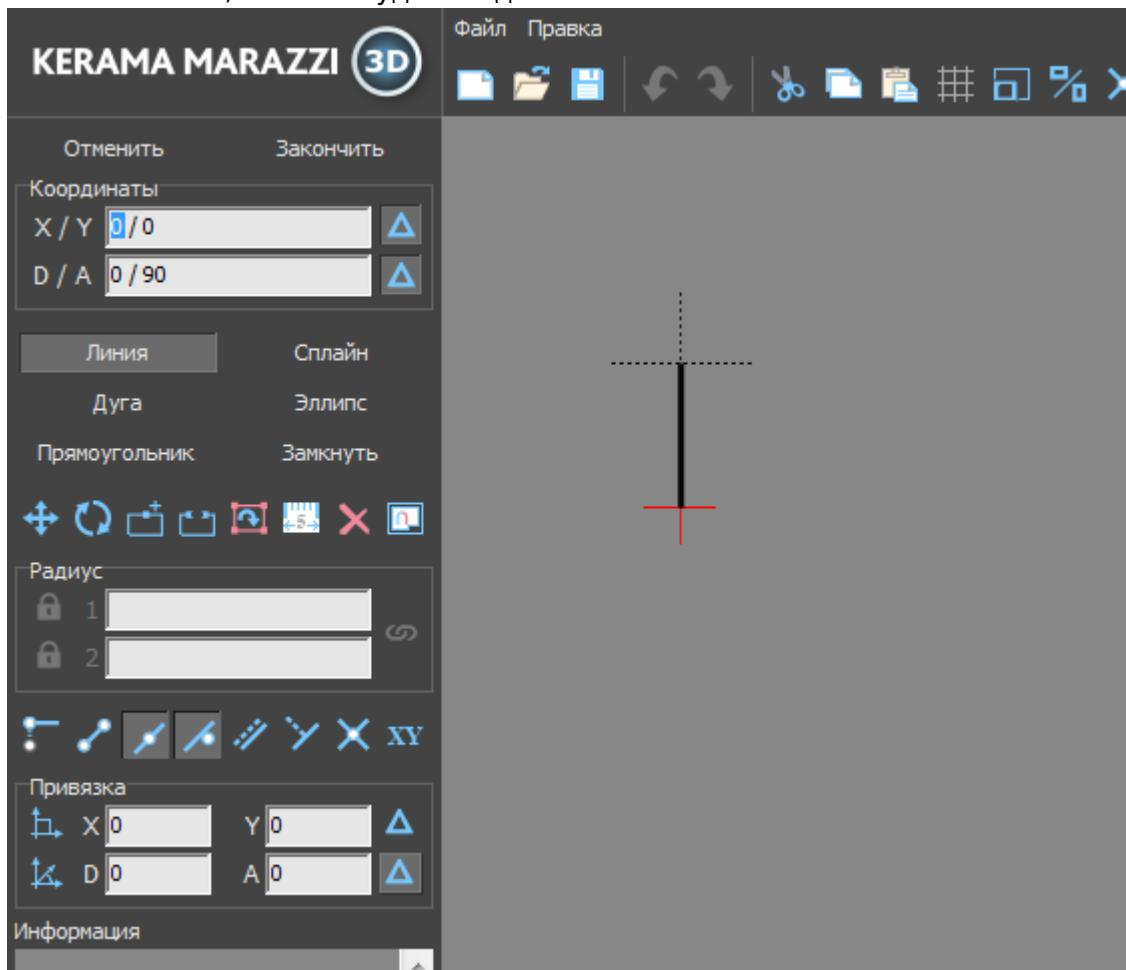
Для построения следующего отрезка не нужно строить начальную точку – ей является последняя построенная точка. Указываем только координаты следующей точки. Поскольку для построения следует поставить точку слева относительно текущего положения, **задаём отрицательное значение X:**
