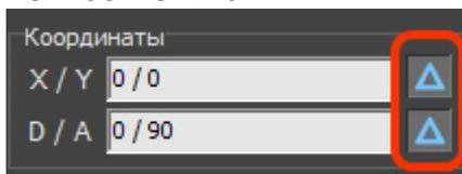
Если эта функция включена (нажата кнопка), построение линии (или другой фигуры) продолжится из той точки, где было закончено построение предыдущего отрезка. Если эта функция не включена, отрезок будет строиться из точки начала координат.
