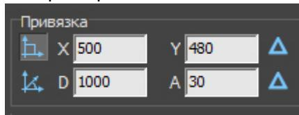
Например, нужно построить помещение, у которого длина стен кратна 1000 мм. Для этого:
