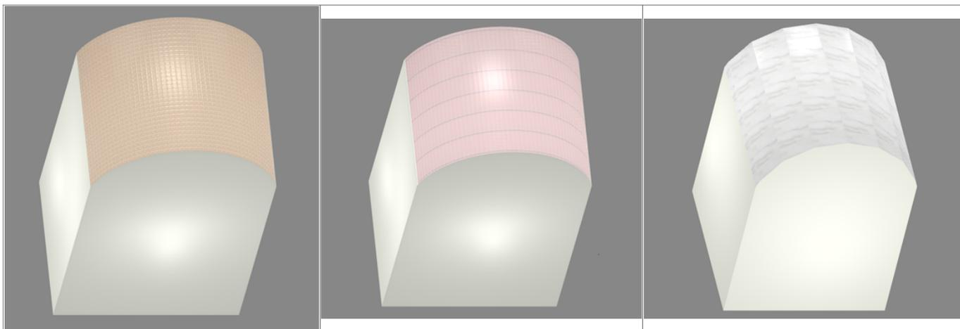
Укладывать плитку на криволинейную поверхность можно точно так же, как и на все прочие. **При первой укладке плитки криволинейная поверхность автоматически разбивается на сегменты по размеру плитки.**
