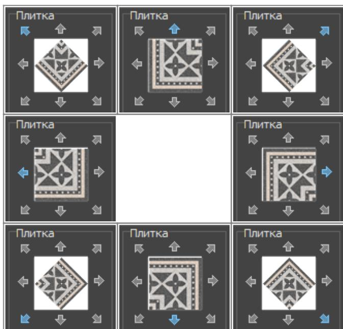
Диагональное положение плитки в данном случае соответствует повороту плитки на 45 градусов.
